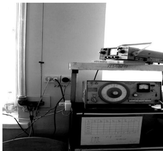
Рис. 6.2. Установка для наблюдения звукового резонанса
