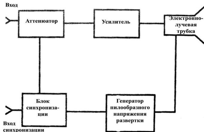
*Рис. 2.5. Блок-схема осциллографа*
